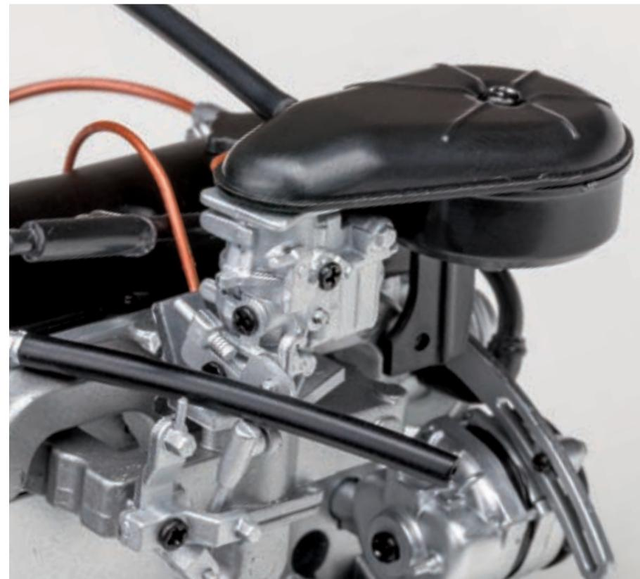
**Шаг 9.** Закрепите вертикальный элемент кронштейна воздушного фильтра на головке блока винтом 2,0×4 (GM). Аналогичным образом зафиксируйте горизонтальный элемент кронштейна воздушного фильтра возле крышки головки блока винтом 1,7×4 (СМ).
