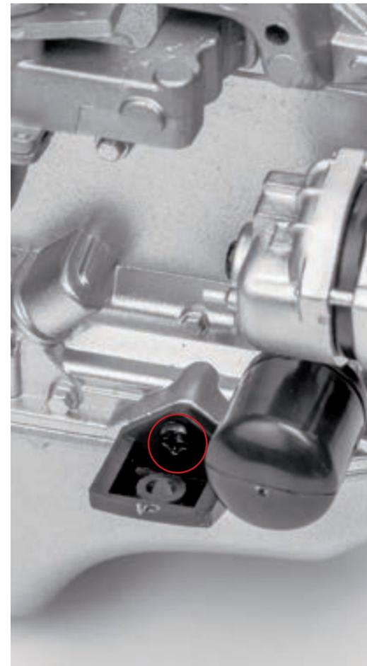
**Шаг 2.** Закрепите собранный ранее элемент двигателя с картером. Установите блок двигателя поверх картера, совместите крепежные отверстия блока с отверстиями внутреннего кронштейна картера и закрепите детали двумя винтами 2,0×4 (GM).
